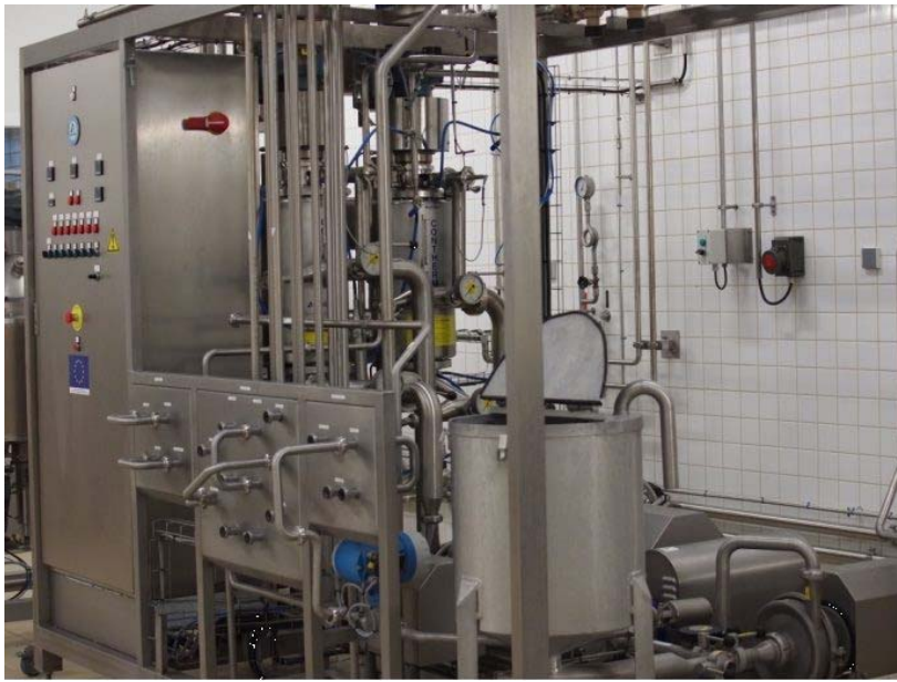
La fabrication de cream cheese : échangeur thermique à surface raclée
